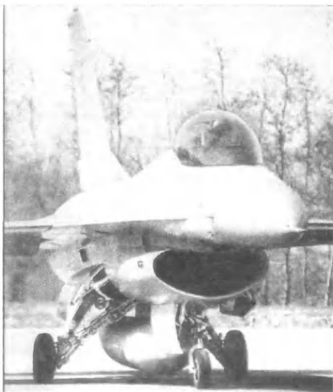
Датский F-16C с подвесным топливным баком.
